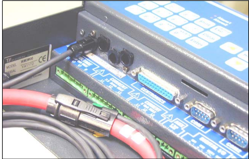
Fig. J-1 – Connettori degli ingressi XCA da anello flessibile di Rogowski sul pannello anteriore
